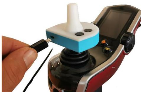
Collegare l'estremità micro B del cavo al Joytojoy e l'estremità USB di tipo A all'apparecchio da controllare. Su un PC, collegare il cavo a una porta USB standard.
