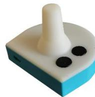
Joytojoy è un dispositivo versatile progettato per consentire agli utenti di sedie a rotelle elettriche di giocare ai videogiochi su PC e console e di controllare un mouse su computer, smartphone e tablet. Utilizza un sensore di movimento che traduce le azioni eseguite sulla levetta della sedia a rotelle in un segnale adatto per ogni sistema da controllare.
